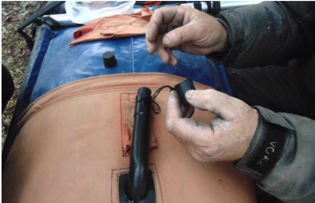
Фото 06.05. На Судне-1 прочно привязываем капроновыми нитками затычки штуцеров
