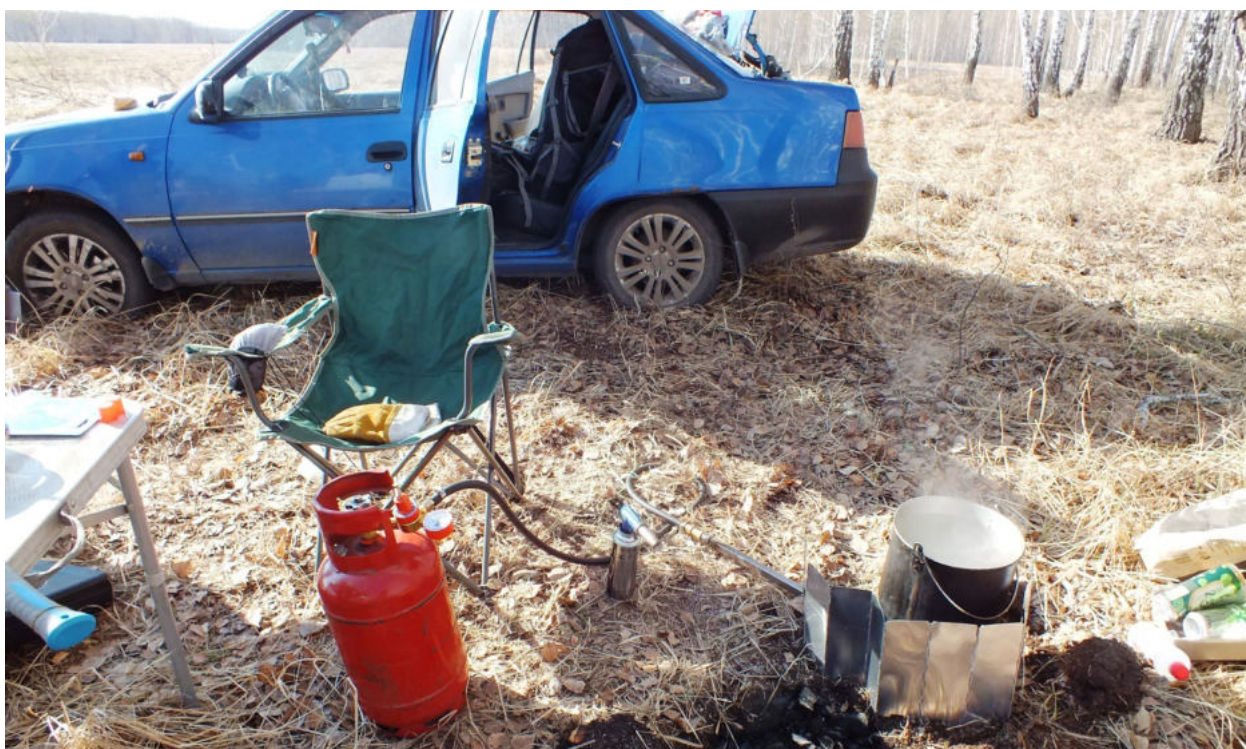
Фото 03.07. Большая горелка. Давление регулируется тремя вентилями. Длинная металлическая «ручка», непосредственного контакта с огнем у дежурного нет (как у маленькой горелки)
